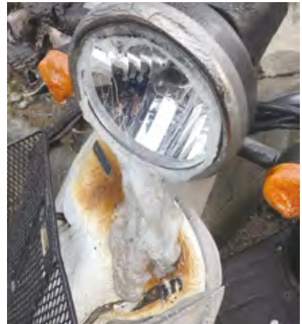
▶激しい火災でヘッドライトが溶けているバイク(令和3年2月の火災現場にて撮影)
